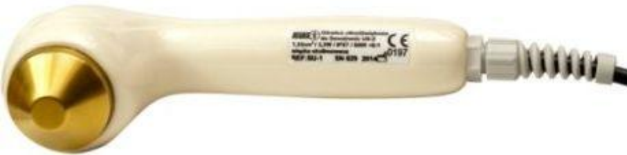
Głowica ultradźwiękowa SU-1: 1,33cm 2 / 1MHz i 3,3MHz
